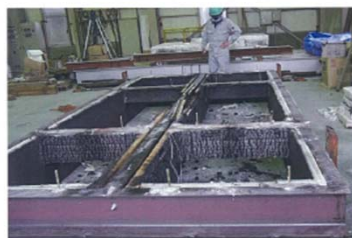
床との取り合い部試験体 NO1(加熱 24 時間後)
